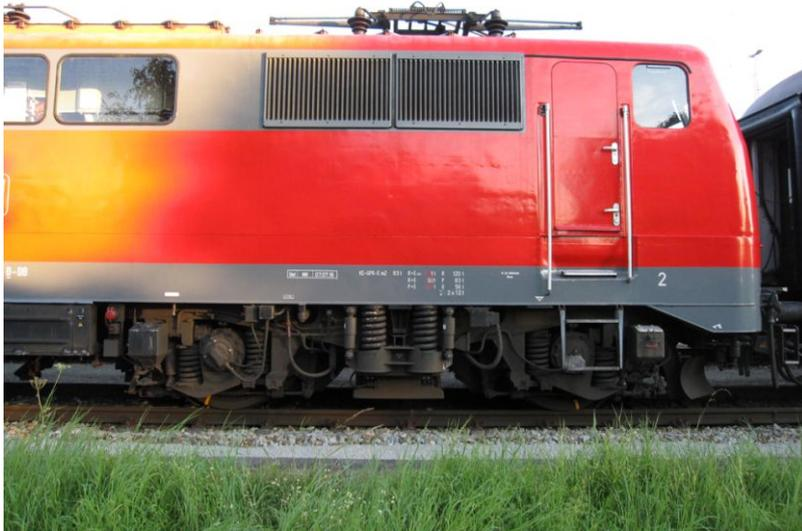
BR111: Schaltwerkslokomotive mit Gummiringfederantrieb
