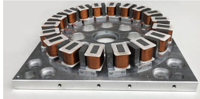
Statorhälfte mit aufgeschraubten U-Jochen
