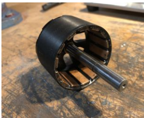
Rotor mit 14 Magneten NdFeB, verkupfert in die Rotorglocke eingeklebt
