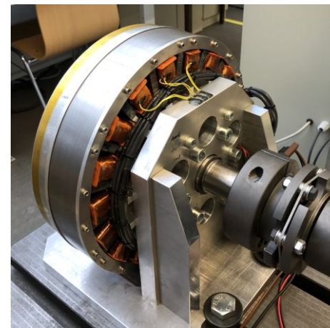
Radialflussmaschine mit U-Jochen, Prototyp Außenläufer
