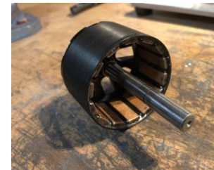
Rotor mit 14 Magneten NdFeB, verkupfert
