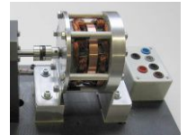
16 W - Versuchsmotor (Axialflussmaschine)
