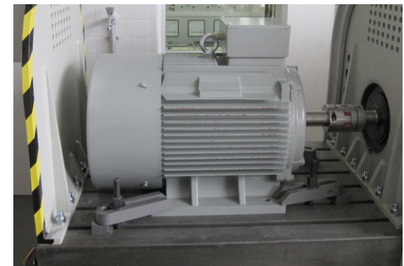
55 kW- Standardmaschine, mit Kupplung
