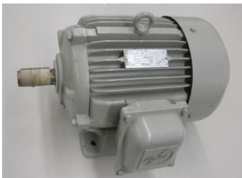
4 kW - Maschine, 80er-Jahre aus Niederbayern (Loher)
