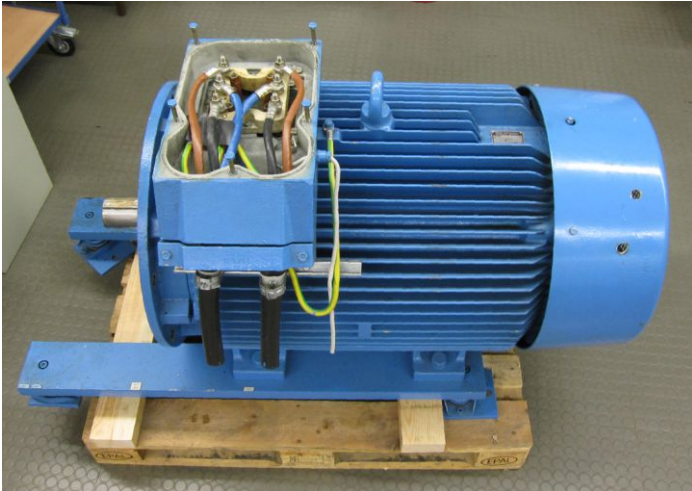
200 kW - Maschine, p = 2 , Stern-Dreieckanlauf
