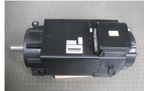
Maschine für Umrichterbetrieb 78 kW, p = 4 , N_N = 3600 Upm
